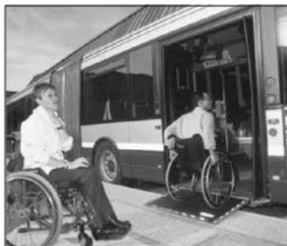
Схема 29 – Пример применения механической аппарели автобуса на посадочной площадке в габаритах места посадки инвалидов
