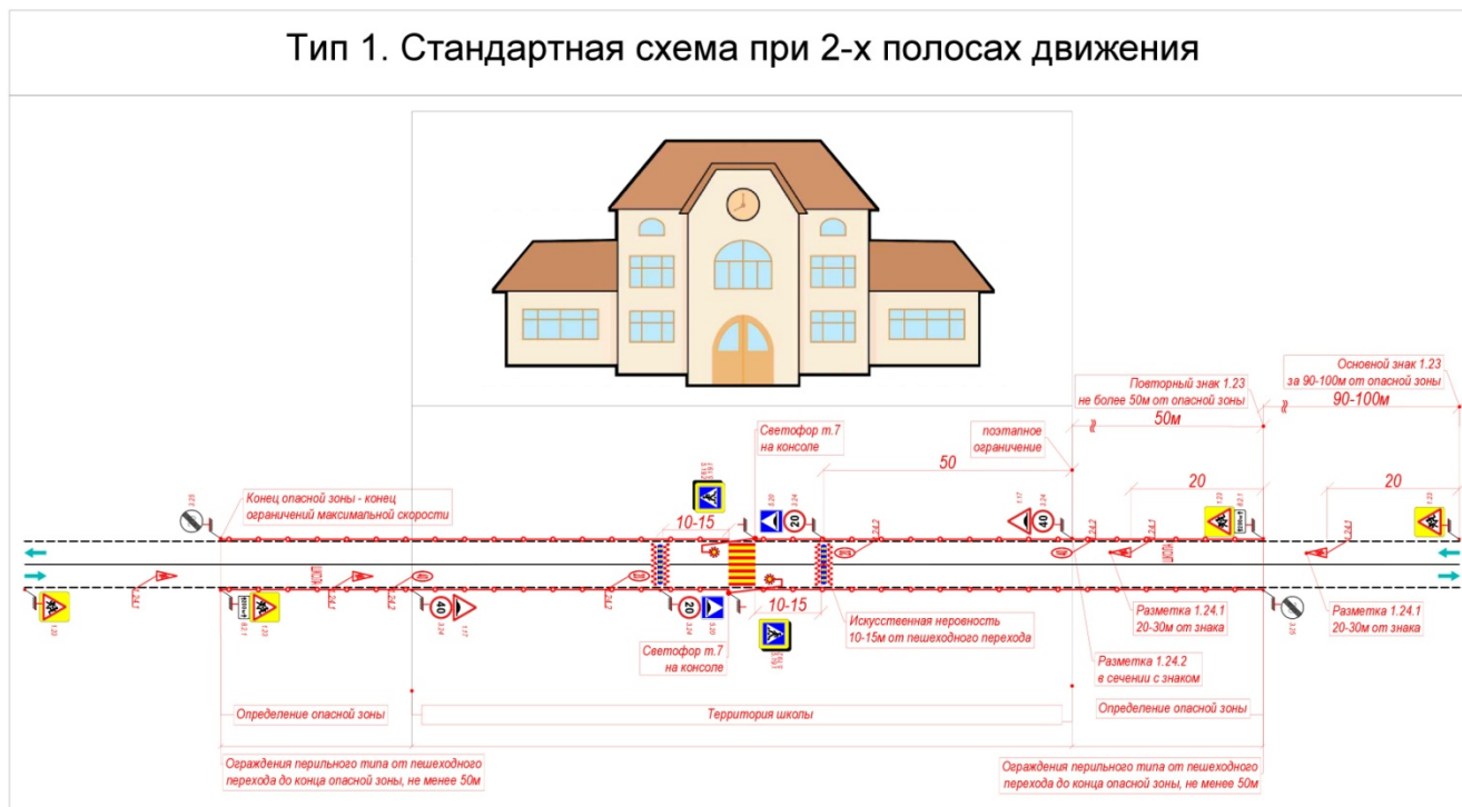
Схема 33 – Схема типового мероприятия по обеспечению БДД в районе детских учреждений при условиях «1+1» полосами для движения
