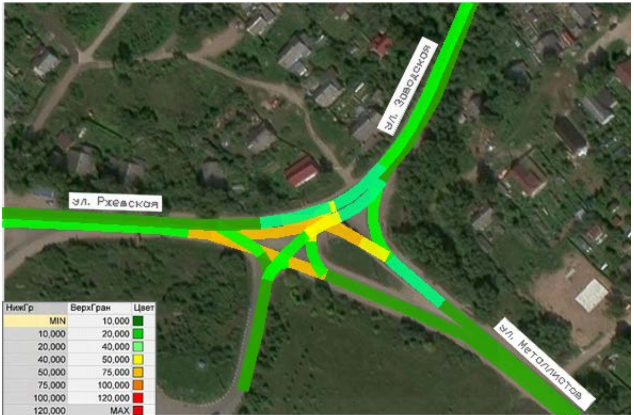
Схема 36 – Картограмма скорости транспортного потока на пересечении ул. Ржевская – ул. Заводская – ул. Metallистов (Масштаб 1:5000)
